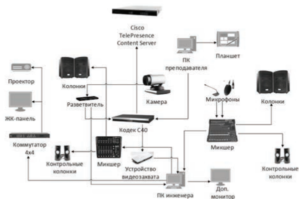
Рисунок 1 – Схема подключения оборудования центра видеоконференцсвязи
