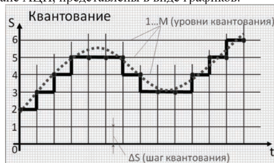
Рисунок 2 – График процесса квантования
