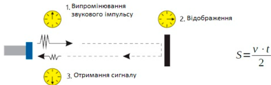
Рисунок 4 – Схема роботи ультразвукового датчика
