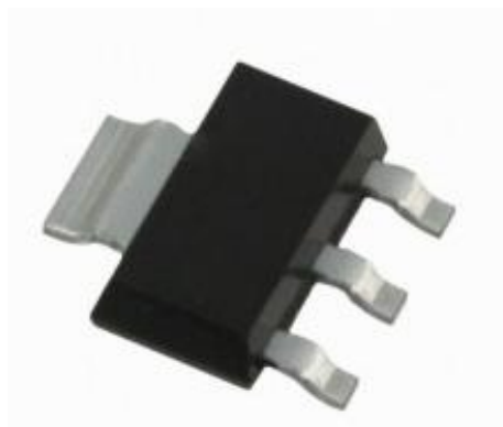
Рисунок 2.10 – Загальний вигляд стабілізатора напруги AMS1117 3.3 В [41]
