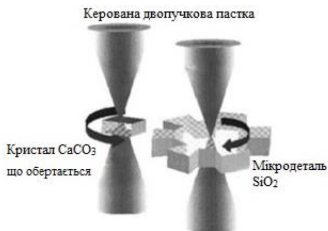
Рисунок 2.1 – Передача обертального моменту від двопротенезаломлюючого кристалу кремнівості шістки
