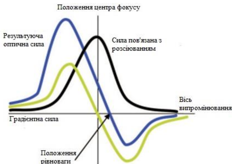
Рисунок 1.3 – Додавання сили, пов'язаної з розсіюванням випромінювання, та градієнтної сили при оптичному захопленні мікрооб'єкта
