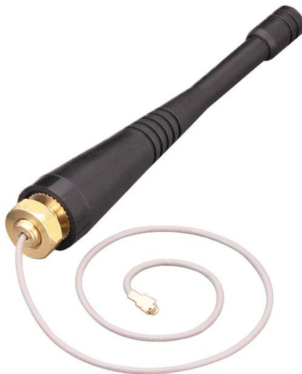
Рисунок 2.10 – Антена ANT-B20-CW-QW-SMA для зв'язку з мережами NB-IoT [54]
