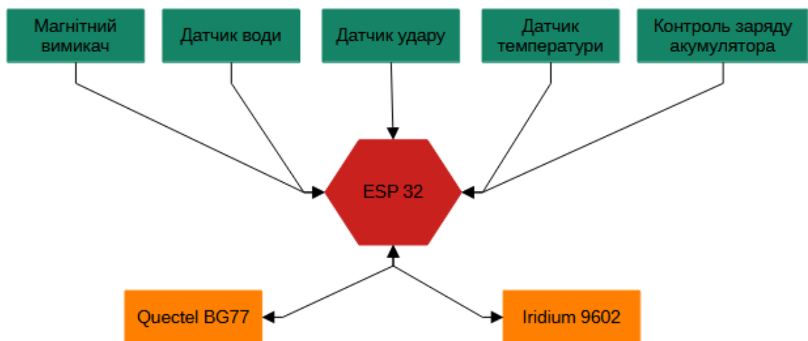
Рисунок 2.12 – Спрощена блок-схема підключення
