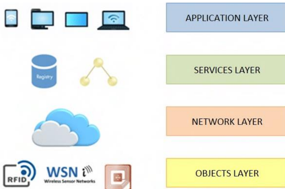
Рисунок 1.1 – Архітектура на основі SOA для програмного забезпечення IoT [9]
