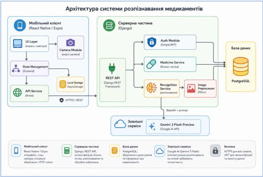
Рисунок 3.1 – Діаграма компонентів мобільного застосунку для обліку лікарських засобів
