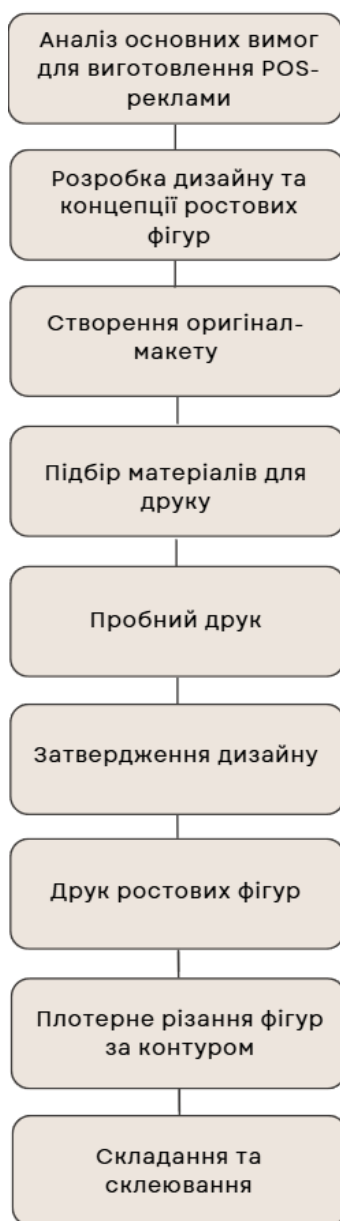
Рисунок 4.1 – Технологічна схема виготовлення ростової фігури
