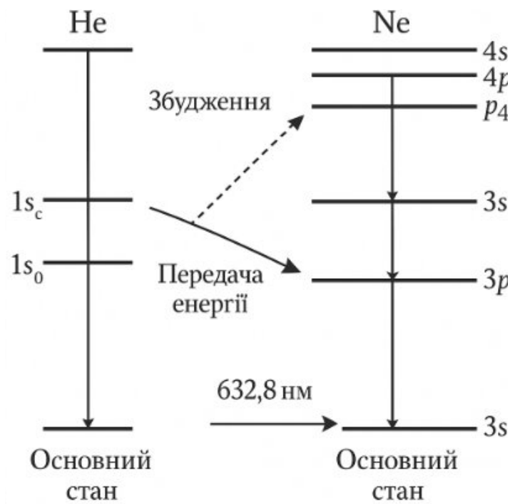
Рисунок 2.1 – Схема енергетичних рівнів He-Ne лазера та передача енергії між атомами He і Ne
