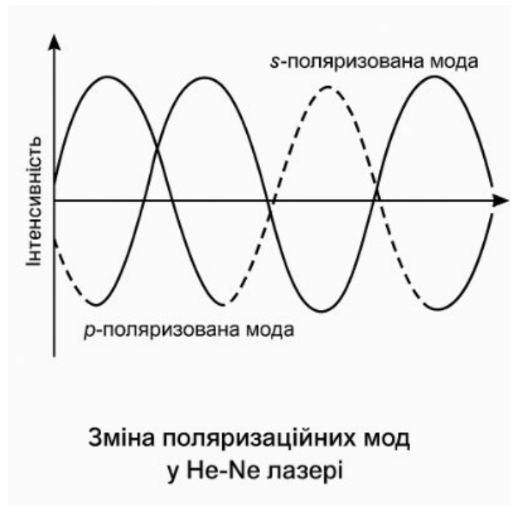
Рисунок 2.2 – Діаграма зміни поляризаційних мод у He-Ne лазері
