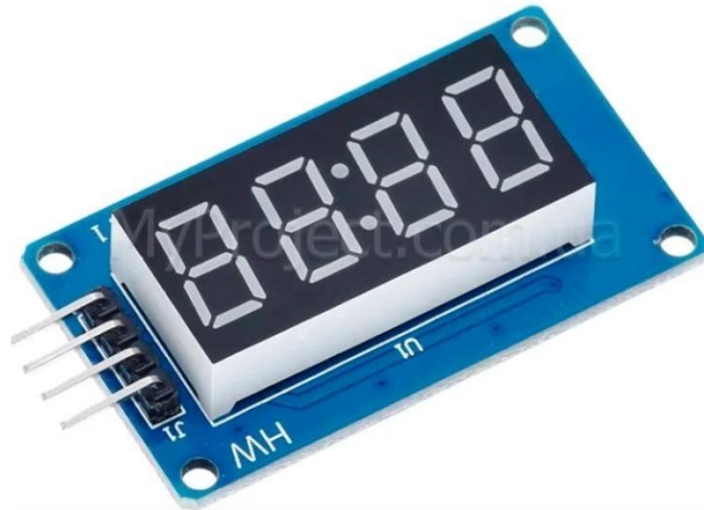
Рисунок 2.11 – Модуль HW-069 чотирьох-розрядний семи-сегментний індикатор [17]
