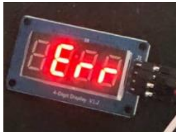
Рисунок 3.31 – Стан помилки під час ініціалізації Err
