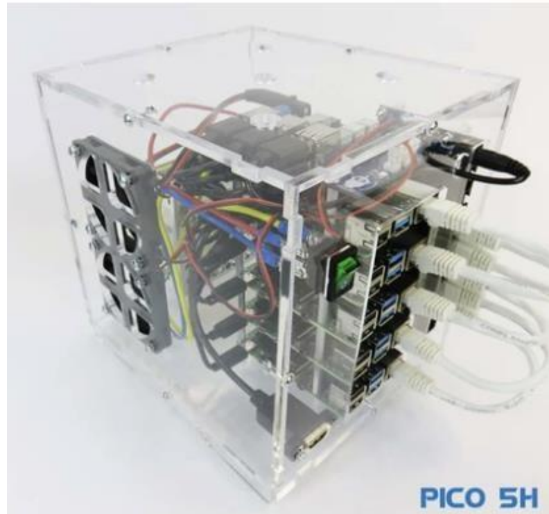
Рисунок 2.2 – Pico Cluster на основі п'яти Raspberry Pi 4 [8]
