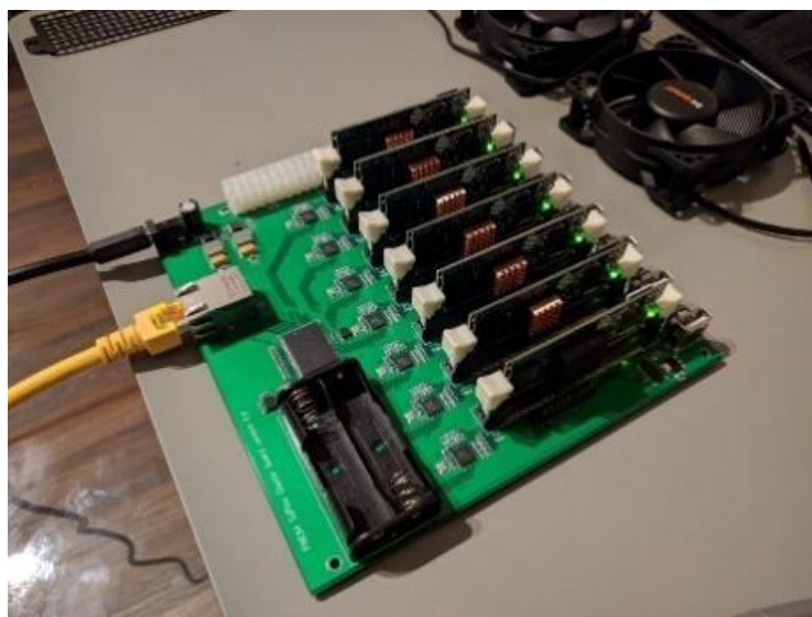
Рисунок 2.3 – SOPINE Clusterboard плата з 7 модулями SOPINE A64 [9]
