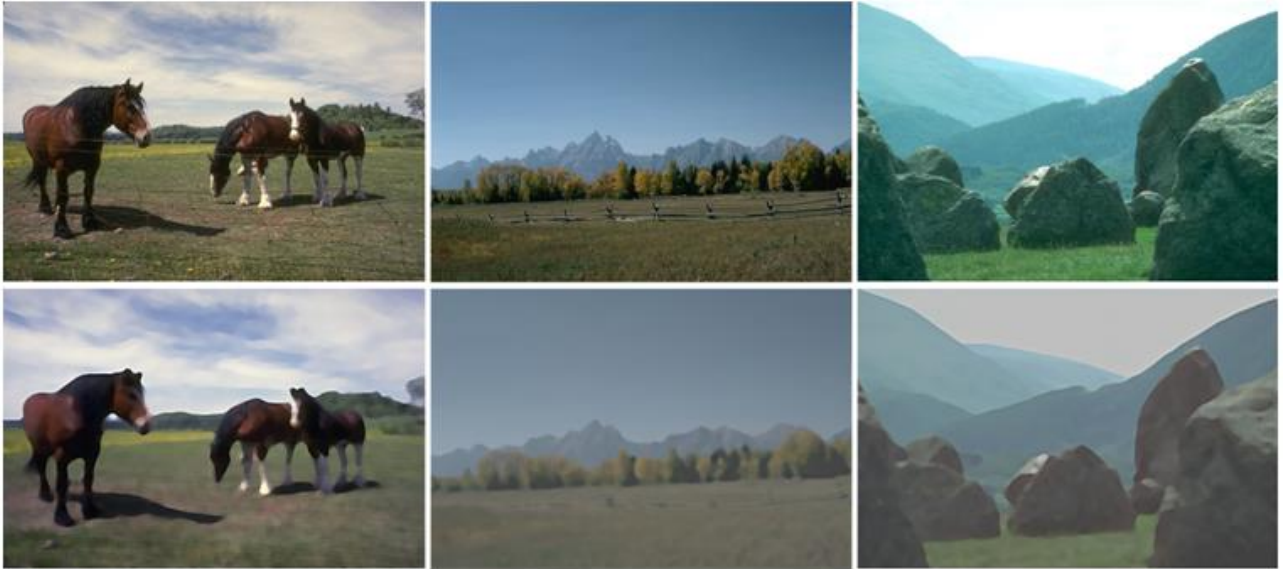
Рисунок 6.15 – Приклади вихідних зображень (верхній ряд) і результатів медіанної фільтрації (нижній ряд)
