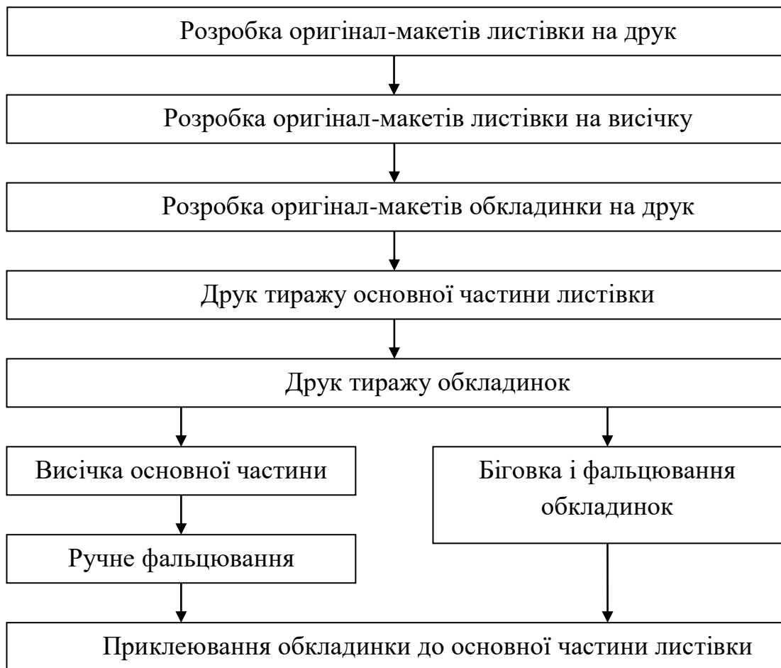
Рисунок 4.1 – Технологічна схема виготовлення об'ємної листівки
