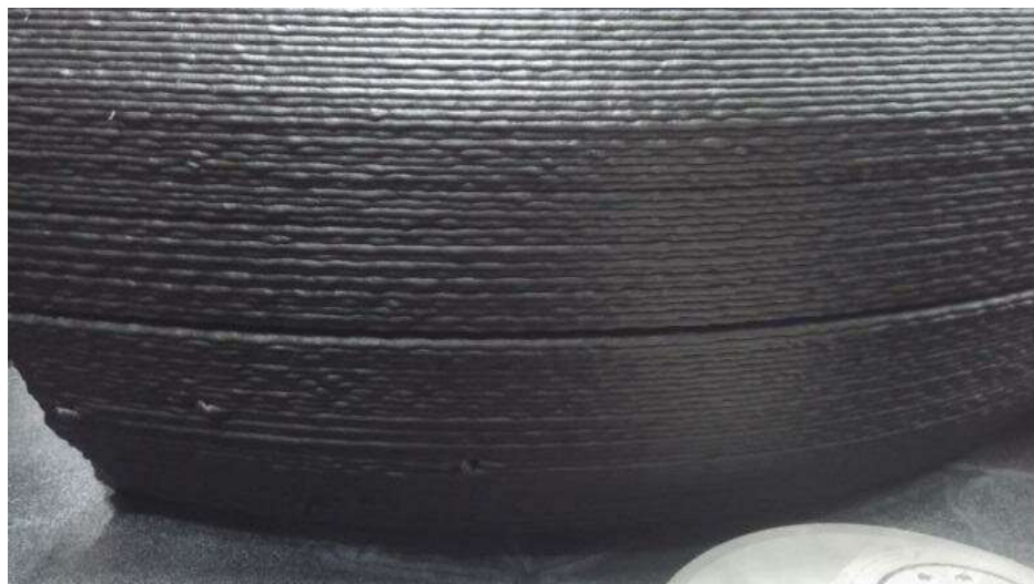
Рисунок 1.16 – Виріб зі щілинами на моделях із тонкими стінками
