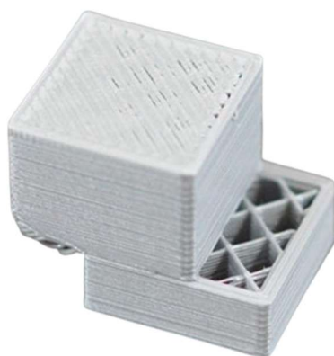
Рисунок 1.11 – Виріб зі зміщенням шарів
