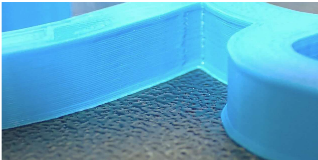
Рисунок 1.14 – Виріб з дефектом «слонова нога»
