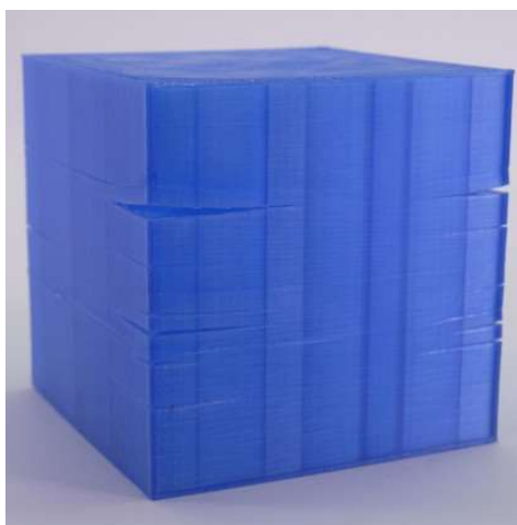
Рисунок 1.13 – Виріб з розщепленням шарів
