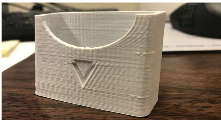
Рисунок 1.15 – Виріб з дефектом «дзвін»
