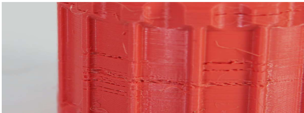
Рисунок 1.12 – Виріб з пропущеними шарами
