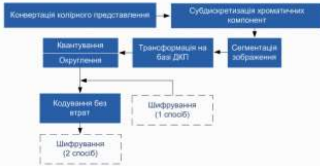
Рисунок 5 – Способи організації технологічного етапу шифрування даних на базі JPEG-платформи
