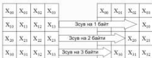
Рисунок 11 – Схематичне зображення виконання процесу ShiftRows
