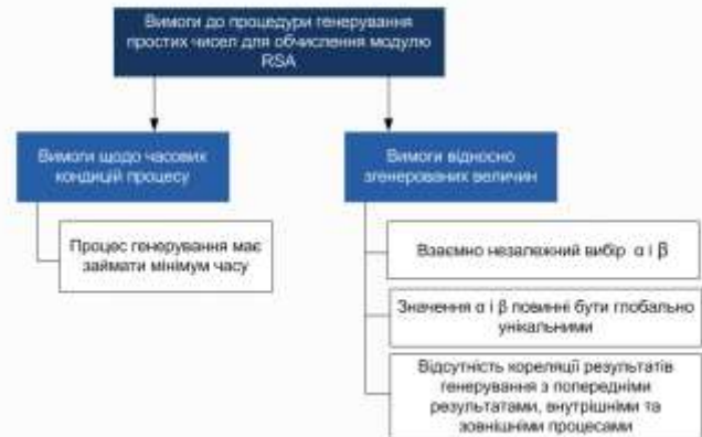
Рисунок 8 – Ключові вимоги до процесу вибору простих чисел для розрахунку модулю RSA
