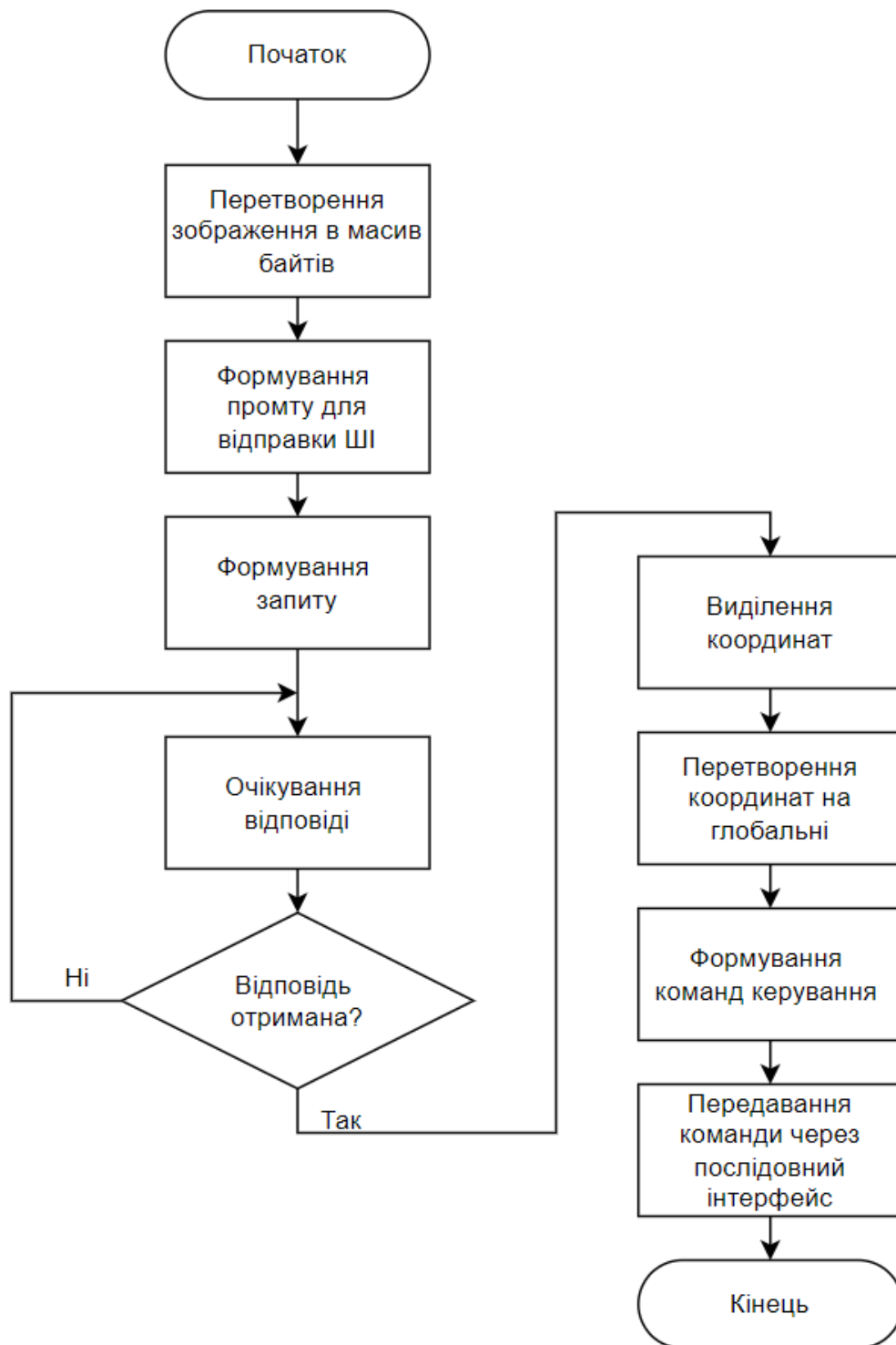
Рисунок 3.3 – Алгоритм роботи автоматизованої системи в режимі використання хмарного середовища зі штучним інтелектом
