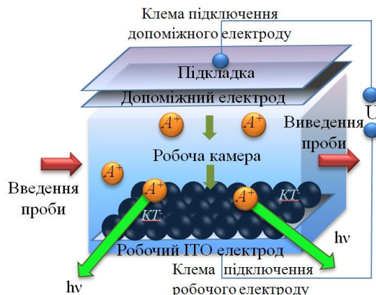
Рис. 3. Схематичне зображення процесу взаємодії КТ з молекулами аналіту
