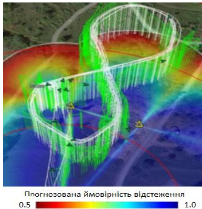
Рис. 1.40 – Схема розгортання 3 вузлів супроводу, прогнозована ймовірність супроводу БПЛА, що маневрує, з використанням декількох вузлів, біла лінія-GPS трек, зелена лінія-акустичний трек, жовті трикутники-розташування вузлів [131]
