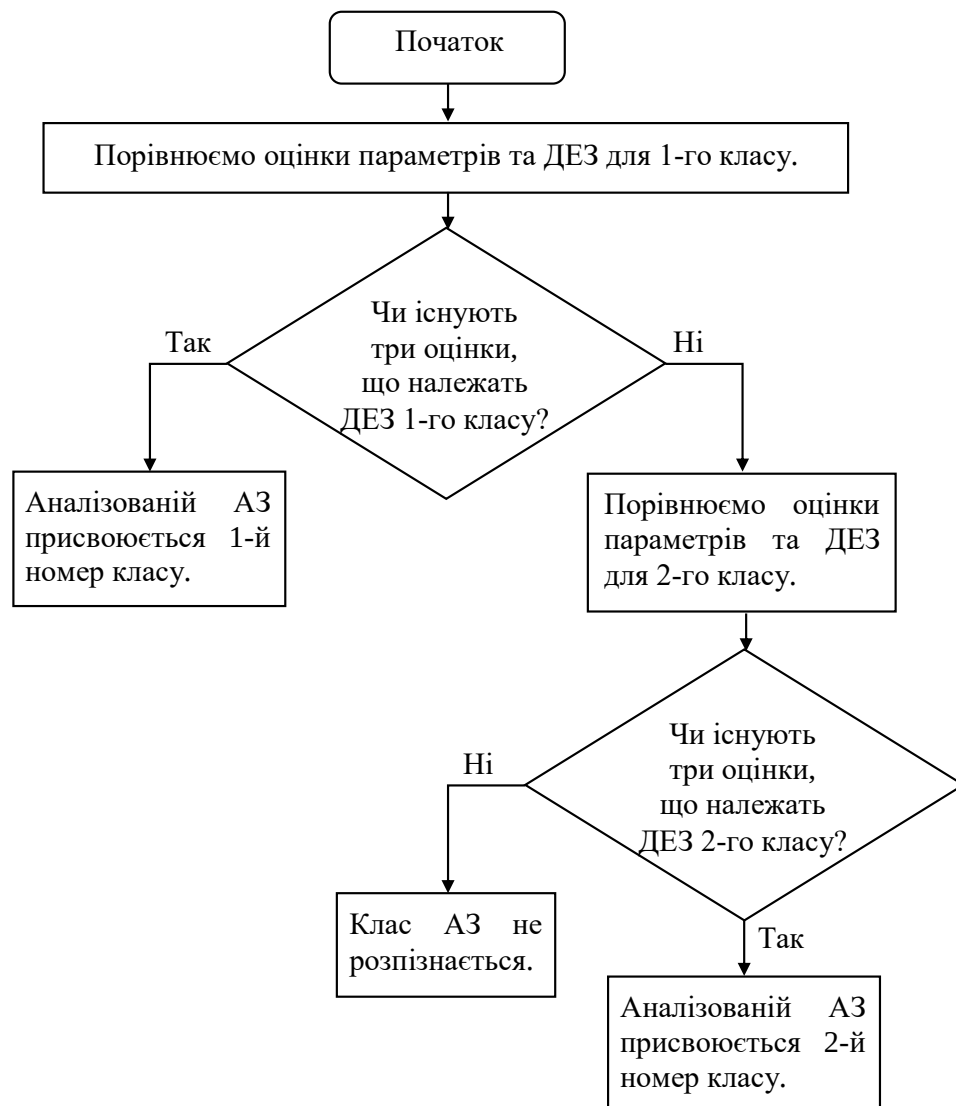
Рисунок 2.18 – Блок-схема алгоритму розпізнавання класу АЗ за 3-ма параметрами та критерієм "3 з 3"
