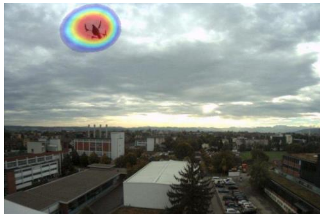
Рис. 1.41 - Образ акустичних сигналів накладений на оптичне зображення квадрокоптера Parrot AR Drone 2.0 [134]
