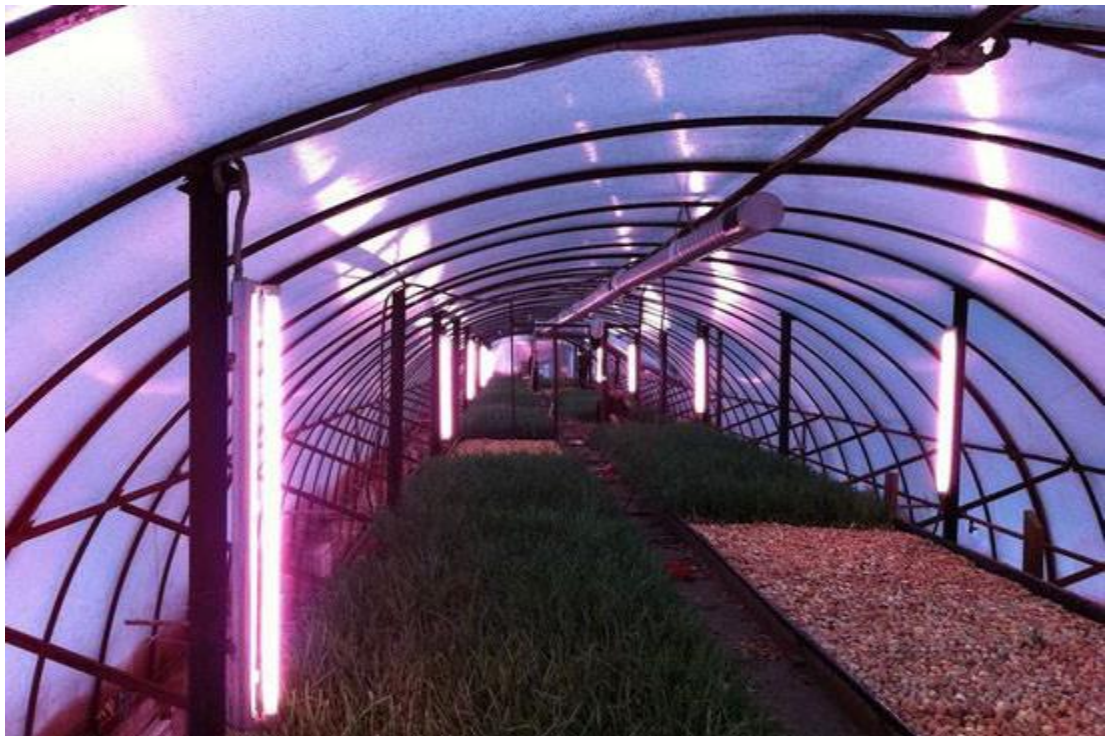
Рисунок 4.2 – Варіант вертикального освітлення теплиці
