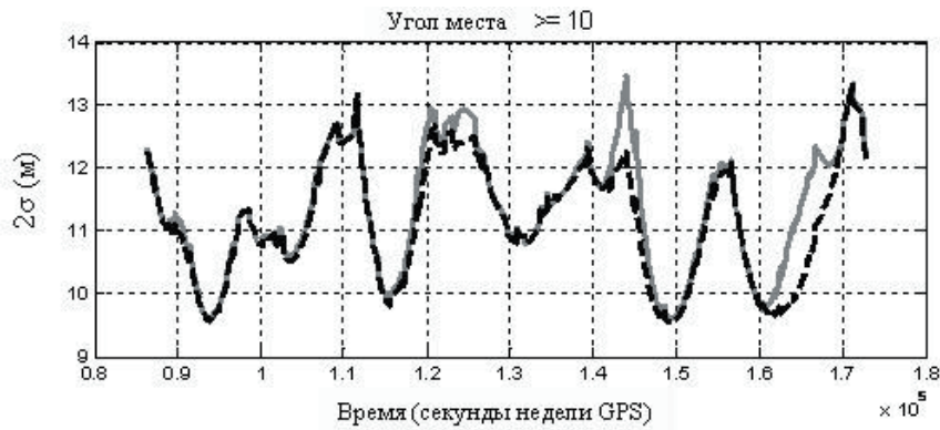
Рис. 5. Точность определения горизонтальной составляющей Запад – Восток: — задача без дополнительного условия; --- задача с дополнительным условием
