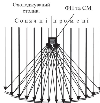
Рис. 2. Структура та принцип роботи мультидзеркального фасеточного концентратора
