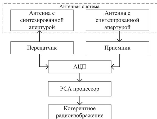
Рис. 1. Структурная схема наземного шумового РСА 8-мм диапазона длин волн
