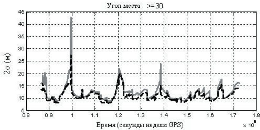
Рис. 4. Точность определения горизонтальной составляющей Юг – Север: — задача без дополнительного условия; --- задача с дополнительным условием
