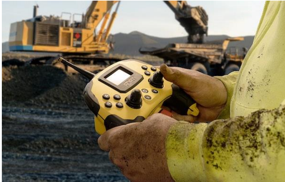
Рисунок 1.8 – Портативний пристрій Safe Remote Control Pro для керування автономними роботизованими пристроями
