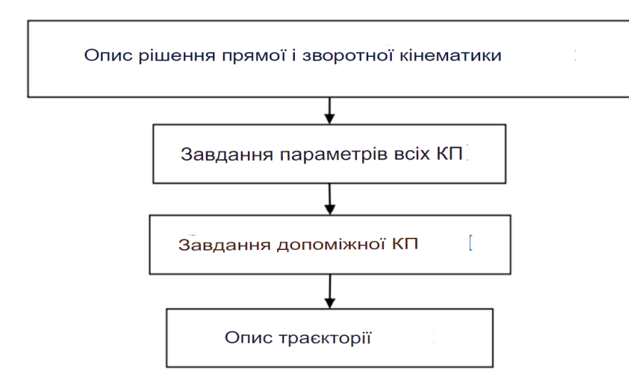
Рисунок 3.5 – Блок-схема моделювання руху кінцевої точки маніпулятора
