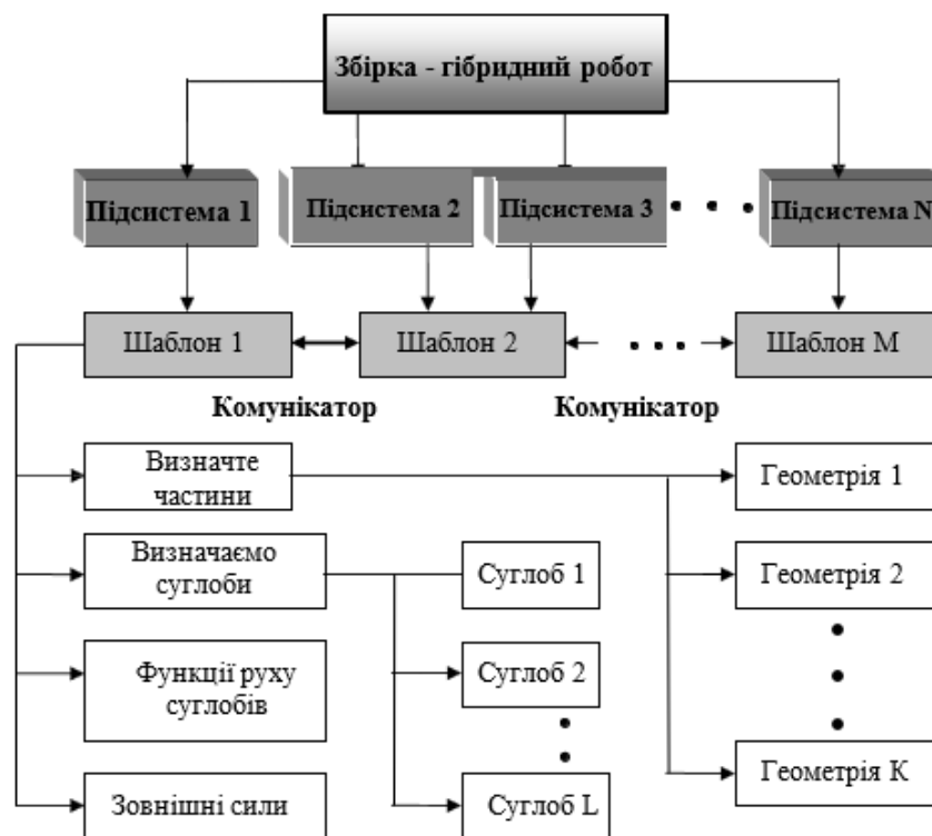
Рисунок 4.2 – Структура моделі віртуального прототипу ADAMS
