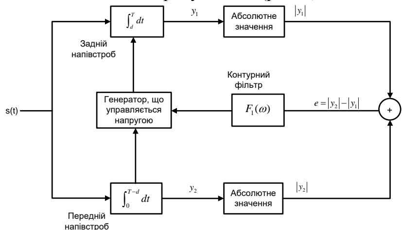
Рис. 1. Схема замкнутого тактового (символьного) синхронізатора
