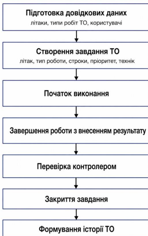
Рисунок 2.1 – Узагальнена модель процесу проходження завдання технічного обслуговування
