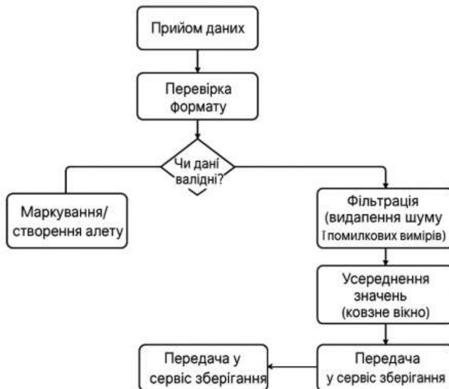
Рисунок 3.2 – Діаграма діяльності сервісу обробки
