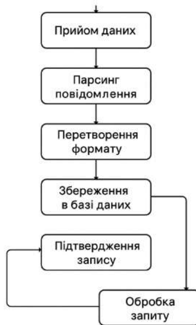
Рисунок 3.3 – Діаграма діяльності сервісу зберігання, реалізованому на базі InfluxDB
