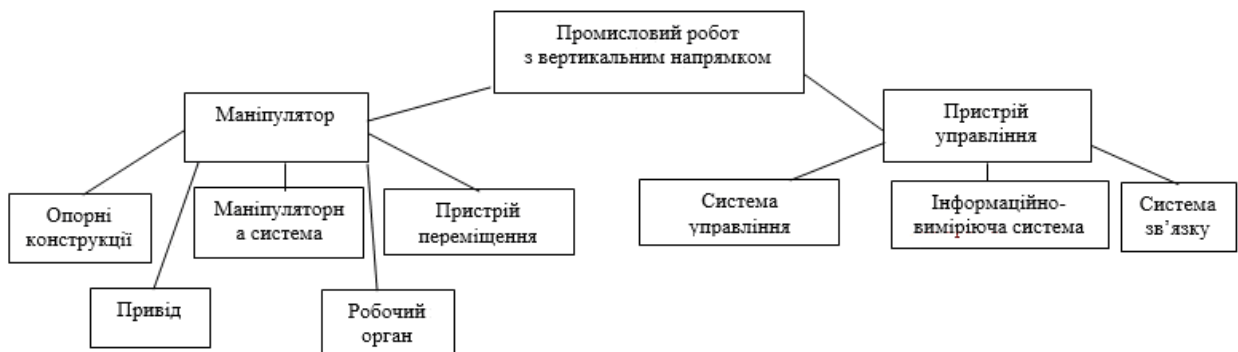
Рисунок 1.5 – Структурна схема складових частин ПМ вертикального переміщення
