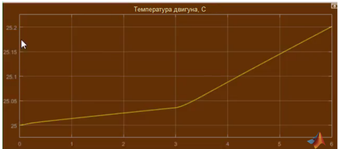
Рисунок 4.8 – Дослідження температури ММП CSMT-04BR1ANT за перші 6 секунд його запуску
