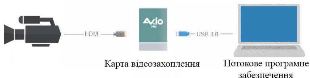
Рисунок 1.2 – Принцип роботи карти відеозахоплення між камерою та ПЗ
