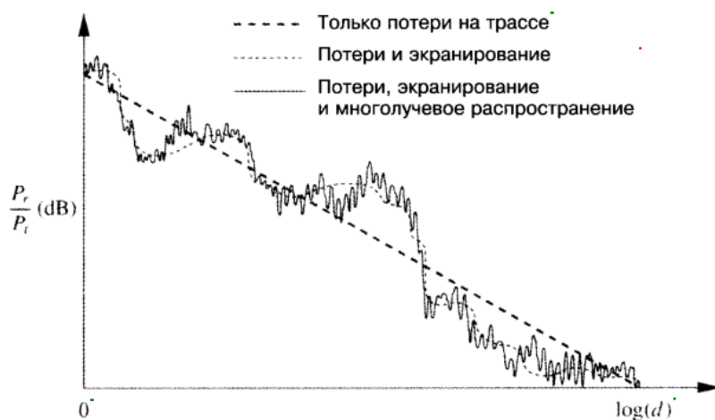
Рисунок 1.5 – Зміна відносної потужності передавача в залежності від логарифма відстані при спільній дії втрат на трасі, пов'язаних з екрануванням та багатопроменевим поширенням радіохвиль.
