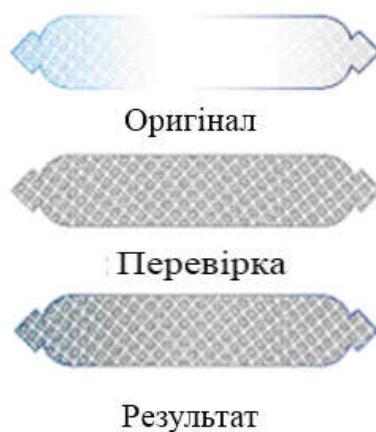
Рисунок 15 – Порівняння сітки антисканера і псевдоірисового друку
