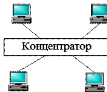
Рисунок 1.4 – Топологія пасивна зірка
