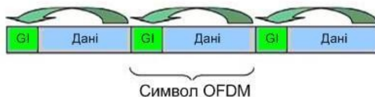
Рисунок 1.4 – Захисні інтервали в структурі OFDM сигналу
