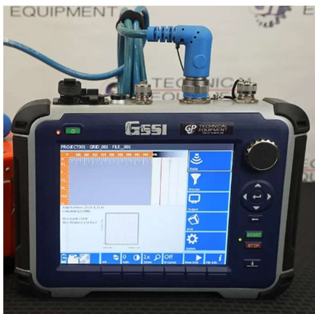
Рисунок 1.7 – Геодар GPR GSSI [16]
