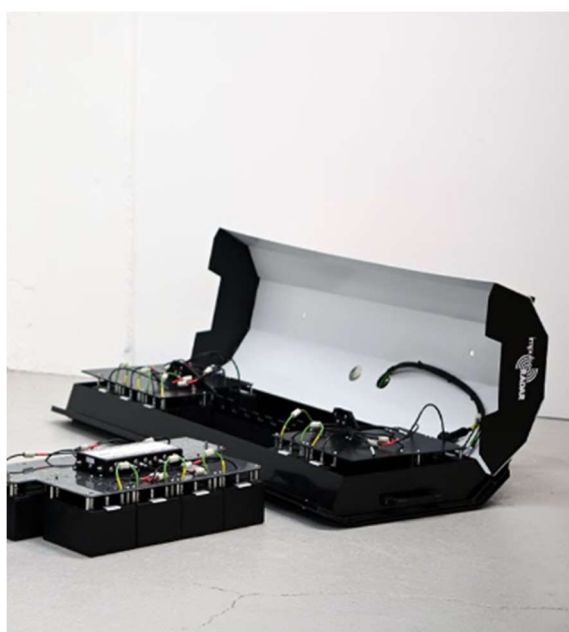
Рисунок 1.8 – Геодар Raptor 40/80 GPR [17]
