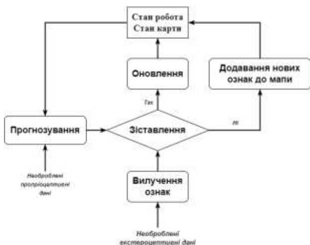
Рис. 1. Блок-діаграма процесу EKF-SLAM
