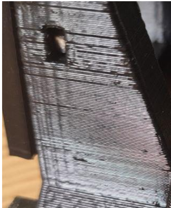
Рисунок 1.1 – Приклад дефекту ghosting / ringing
