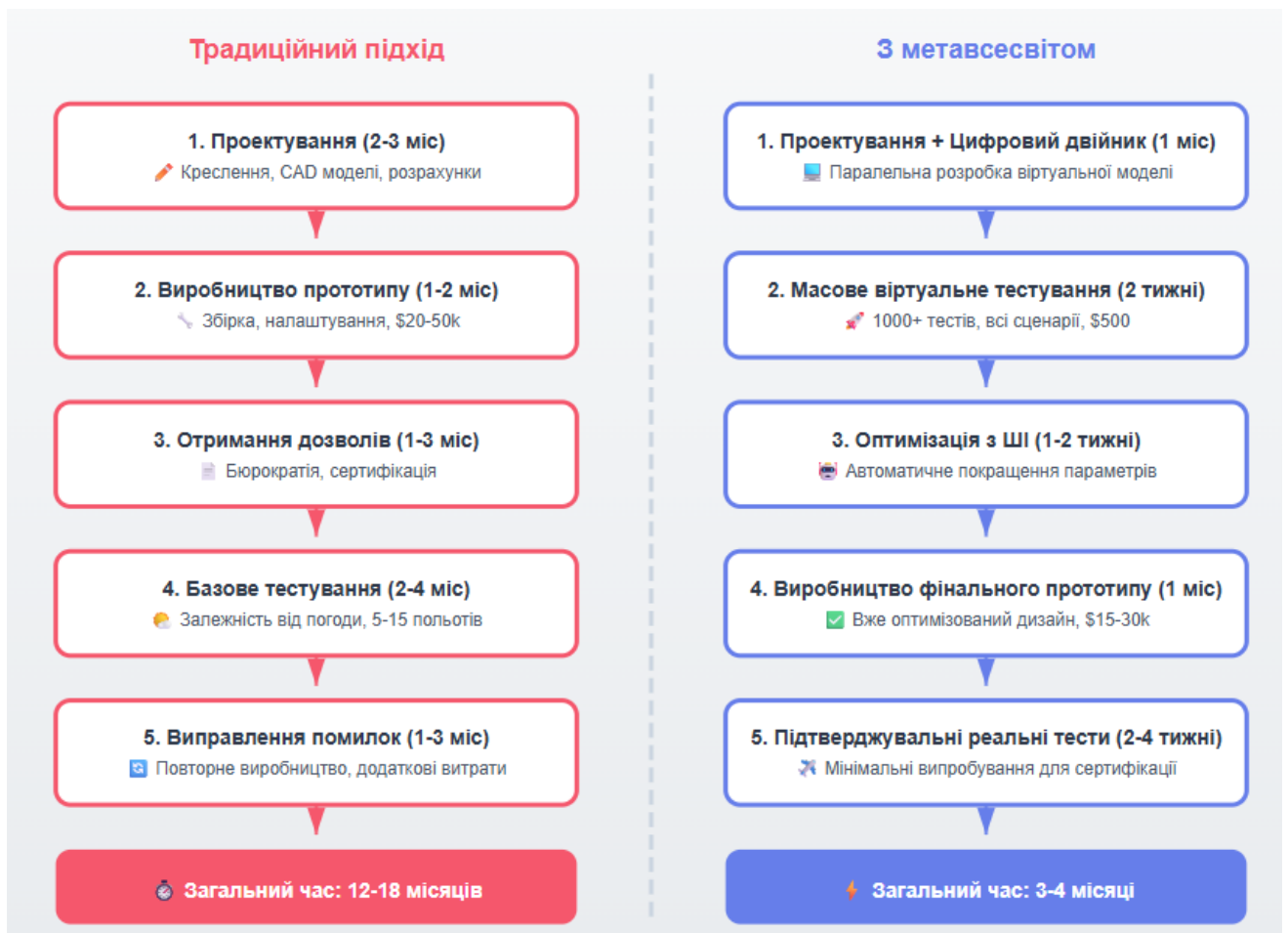
Рисунок 2 – Процес розробки дрона з використанням метавсесвіту
