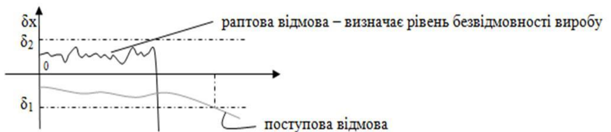
Рисунок 1 – Графік раптової та поступової відмов виробу
