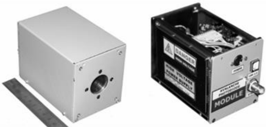
Рисунок 2.6 – Інтегрований фотоприймальний блок
