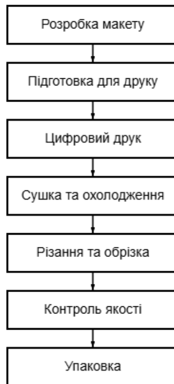
Рисунок 6.1 – Технологічна схема виготовлення візиток і бейджів
