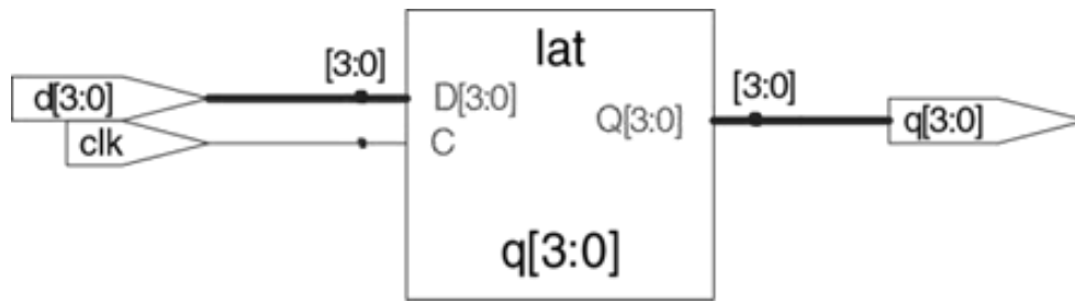
Рисунок 4.19 – Синтезована схема модуля latch
