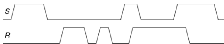
Рисунок 3.60 – Часові діаграми входів RS -тригера-засувки для вправи 3.1
