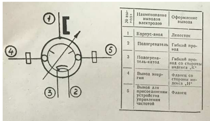
Рисунок 5.25 – Загальний схема підключення магнетронів з двома виводами енергії X та K_U діапазонів
