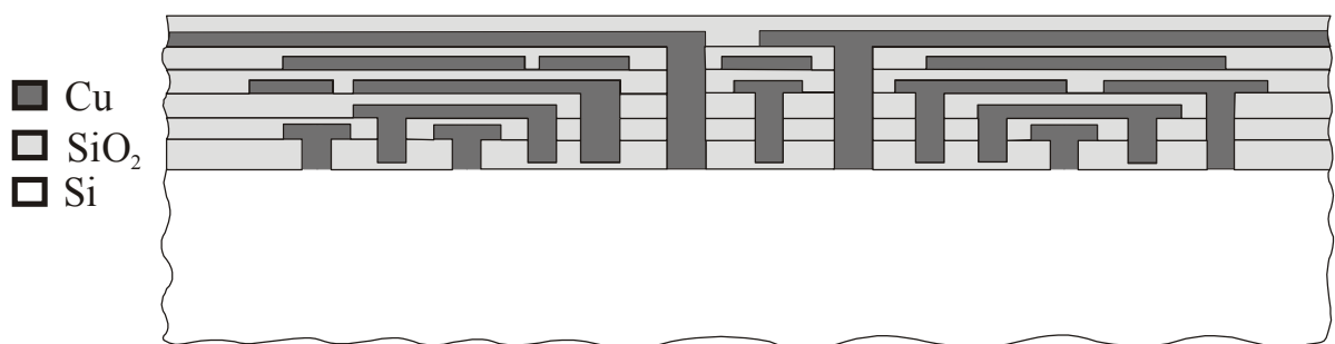
Рисунок 4.3 – Електротеплова модель кристала для ланцюга без активних мікроструктурних елементів
