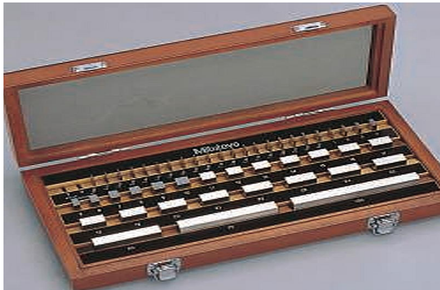
Рисунок 1.4 – КМД, які виготовлені з хромованої сталі
