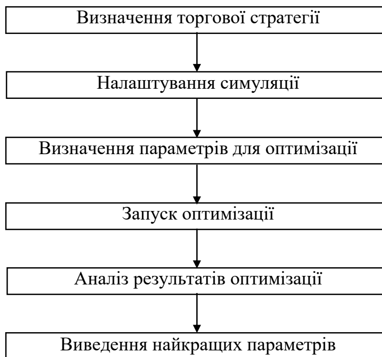
Рисунок 4.6 – Схема алгоритму процесу валідації та оптимізації торгових алгоритмів
