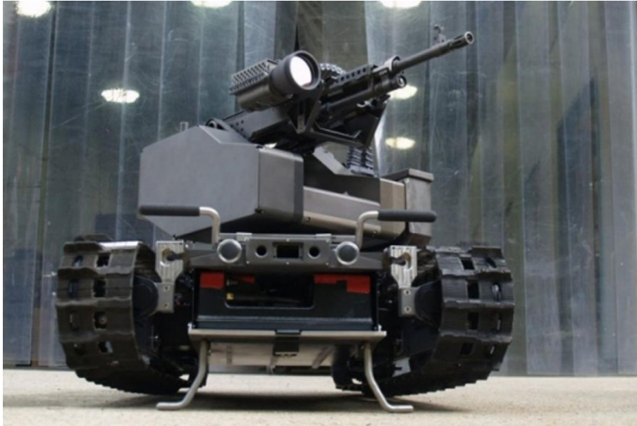
Рисунок 3 – Робот MAARS (Modular Advanced Armed Robotic System) – це наземна бойова платформа, оснащена камерою, маніпулятором та зброєю
