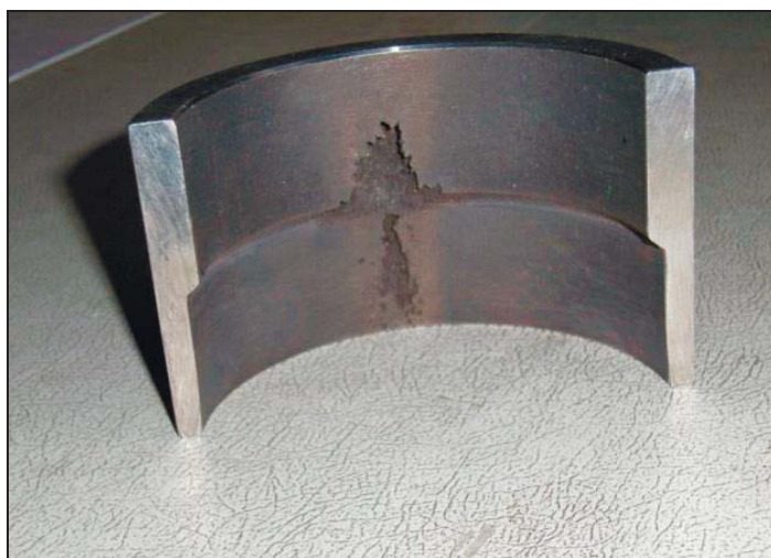
Рис. 3 – Фрагмент трубопровода с кавитационной каверной (дефектом)
