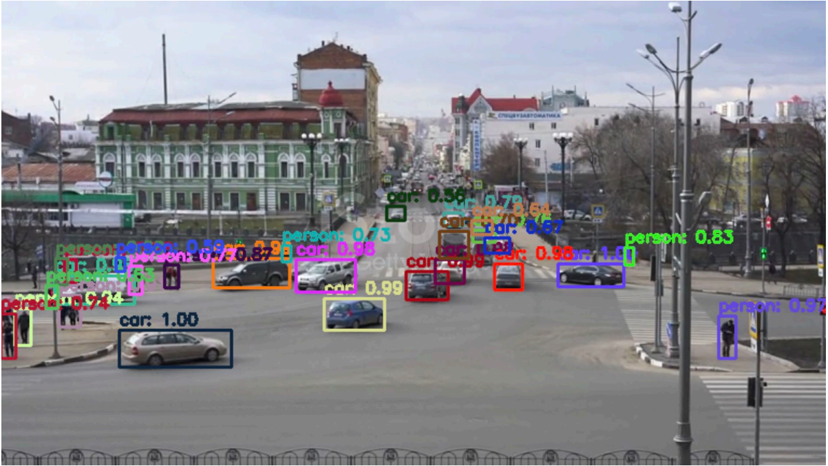
Рисунок 4.2 – Результат роботи алгоритму по виявленню об’єктів на відео
