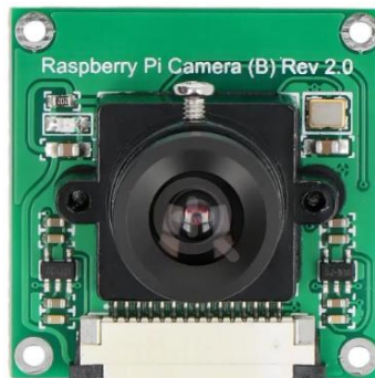
Рисунок 2.6 – Загальний вид камери FPV Waveshare RPi Camera (B) [16]
