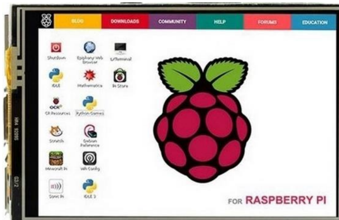
Рисунок 2.5 – Загальний вид дисплея Raspberry Pi 4.0inch LCD 480 × 320 Resistive Touch [15]
