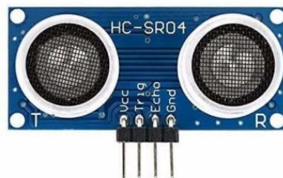
Рисунок 2.4 – Загальний вид ультразвукового датчика HC-SR04 [14]
