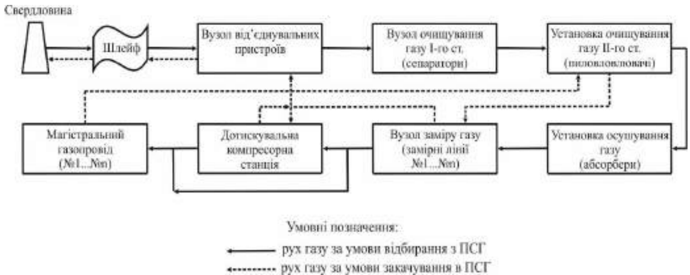
Рис. 1. Принципова технологічна схема відбирання та закачування газу в ПСГ.
