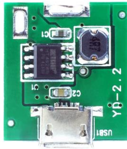
Рисунок 2.3 – Модуль для перетворення напруги з акумулятора у 5 В
