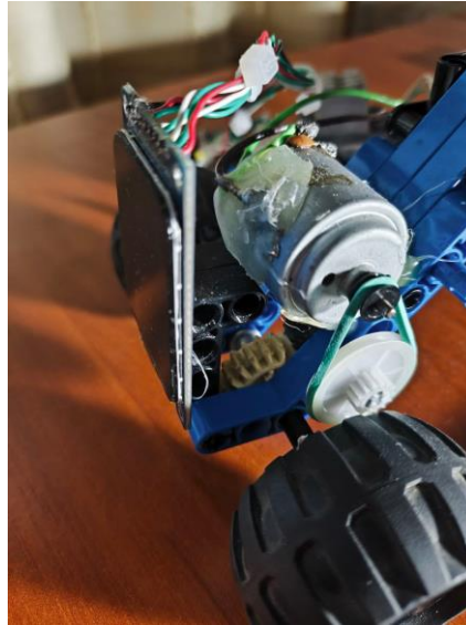
Рисунок 3.3 – Закріплення дисплея на ведучій вісі
