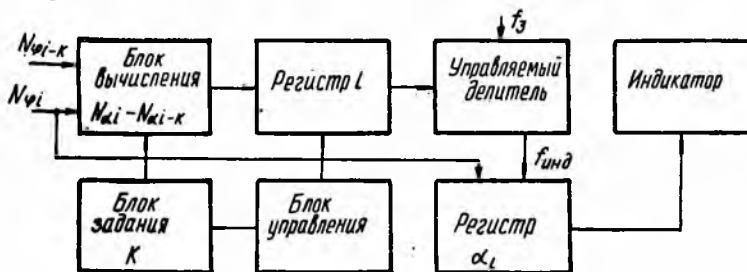
Рис. 3. Укрупненная структурная схема преобразователя скорость — частота
