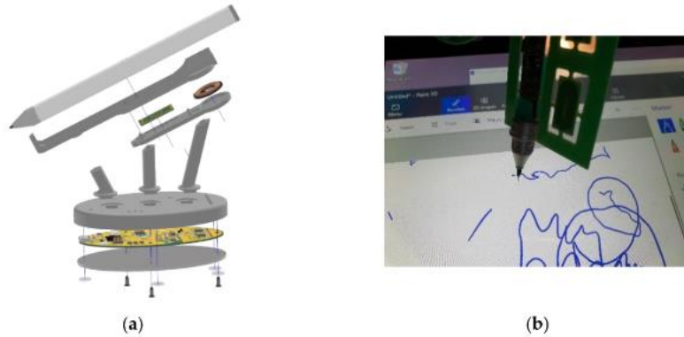
Рисунок 2.13 – (а): конструкція ручки та бездротового зарядного пристрою; (б): ручка під час взаємодії з пристроєм для написання
